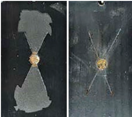
Délamination cathodique d'un revêtement suite essai selon NF EN ISO 15711 Même revêtement avec et sans protection cathodique
