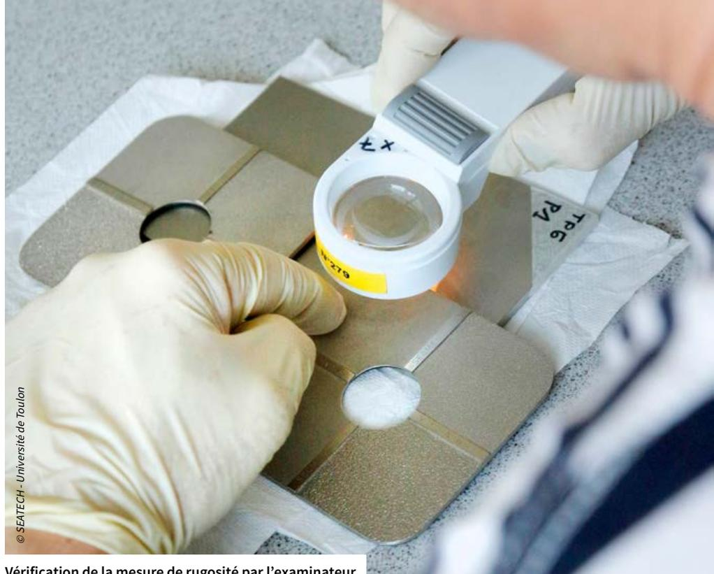
Vérification de la mesure de rugosité par l'examineur
