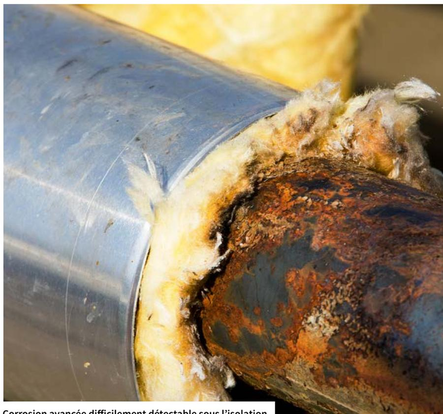
Corrosion avancée difficilement détectable sous l'isolation
