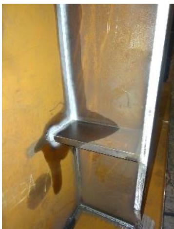
Exemple pour un type de contrôle : la magnétoscopie
