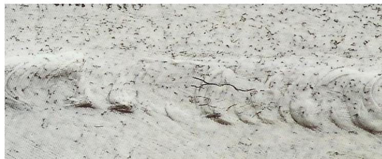
\*NF EN ISO 23278 « Contrôle non destructif des assemblages soudés – Contrôle par magnétoscopie – Niveaux d'acceptation »
